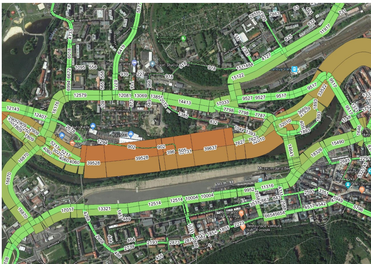
Obrázek 111: Model zatížení IAD ve vozidlech za 24 hodin, výhled roku 2030, pasivní scénář vývoje
