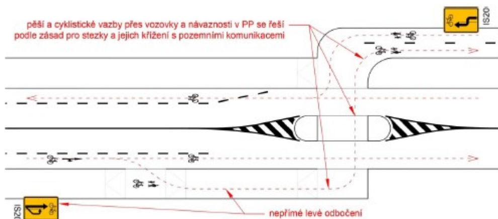
Obrázek 206: Příklad napojení stezky na vozovku s nutností zastavit, s využitím nepřímého levého odbočení dle TP 179
