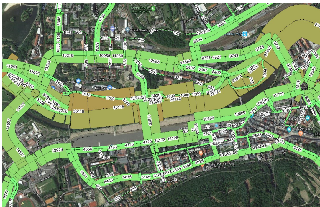
Obrázek 144: Detail dopravního zatížení po vybudování pravobřežní sběrné komunikace v úseku Charkovská-Horova, stav roku 2030
